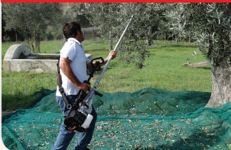
Efikasan stroj za berbu maslina, višanja, šljiva, lješnjaka i sličnih plodova. Ovaj vibracijski tresač olakšava berbu, skraćuje vrijeme branja, smanjuje broj potrebnih pomoćnih radnika.
